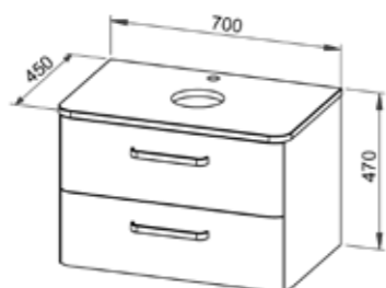
CHARM TOP 70 , 2 predala - združljiv s umivalnikom Top 45 MOŽNOST: brez odprtine za mešalnik
